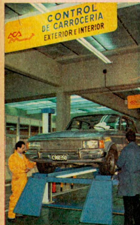
El vehículo es elevado para realizar la inspección exterior de la carrocería.
